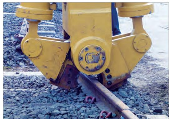
Mobiler Schienenknacker zum Trennen aller gängiger Schienenprofile einschließlich **UIC 60**. TRS-330 trennt Schienen **in jeder Position**, ob aufrecht oder seitlich liegend, 360° drehbar. (Gewicht: 2300 Kg)
