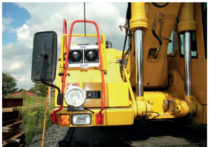
Abb. 9: Funkangesteuerte Warnsignalgeber auf Zweiwege-Bagger (Testeinsatz für akustische Messung BG Bau)
